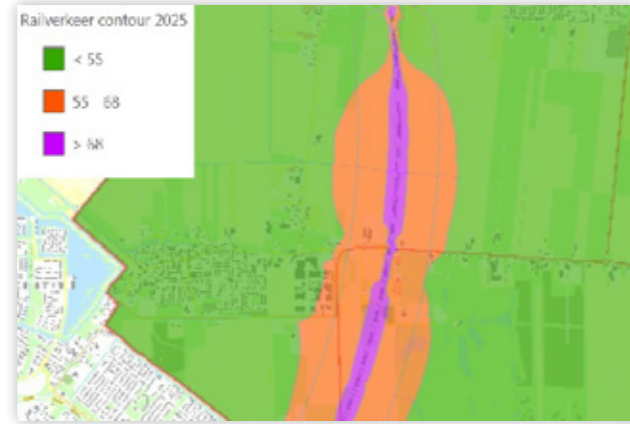
Figuur 4: indicatieve geluidsbelasting railverkeer 2025; bron ODMH.
